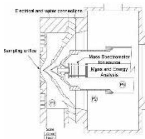
Die Entladung einer Plasmanadel wird mit Hilfe eines dreistufig gepumpten EQP-Systems bei Atmosphärendruck untersucht. Ein integrierter Chopper ermöglicht die exakte Trennung des tatsächlichen Signals vom Hintergrund.
