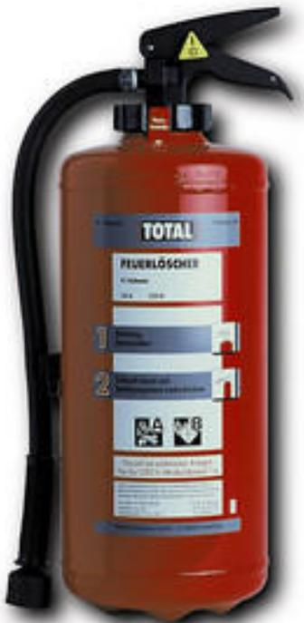
**Bei der Brandklasse A löscht die Kombination von Kühl- und Sperreffekt: Das Wasser senkt die Temperatur unter den Entzündungspunkt und beim Verdampfen bildet sich eine Salzkruste, die ein erneutes Aufflammen unmöglich macht. Bei der Brandklasse B bildet sich ein sehr dünner, gleitfähiger Film auf der brennenden Flüssigkeit, der sich sofort über die ganze Oberfläche ausbreitet und die Sauerstoffzufuhr unterbindet. Der Brand wird erstickt und Rückzündungen werden zuverlässig verhindert.**
