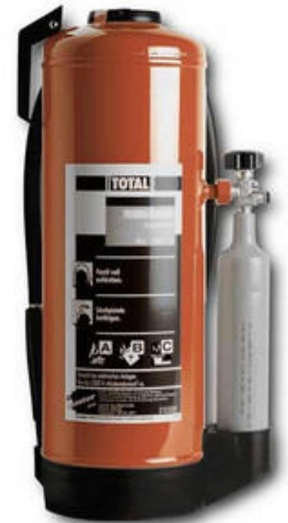
**Pulver-Feuerlöscher bringen Hochleistungen. Die hohe Wirksamkeit der Pulver-Löscher beruht auf einer Kombination aus antikatalytischem Effekt und Sperreffekt. Die winzig kleinen Pulverkörnchen verhindern die für den Brandvorgang notwendige chemische Reaktion - der Verbrennungsvorgang bricht schlagartig zusammen. Bei Bränden mit Glutbildung entsteht durch die Bildung einer Schmelzschicht auf dem Brandgut darüber hinaus ein Sperreffekt, der Rückzündungen verhindert.**
