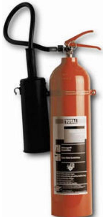
**CO<sub>2</sub> wirkt - in Verbindung mit Löschbrausen - bei flüssigen oder flüssig werdenden Stoffen der Brandklasse B durch den Stickeffekt. CO<sub>2</sub> ist nicht elektrisch leitend**
